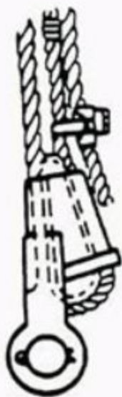
روش بستن انتهای طناب به یک تکه طناب هم سایز توسط کریپی
